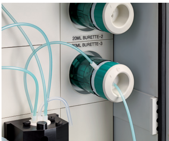
Precision burettes dosing titrants or reagents
