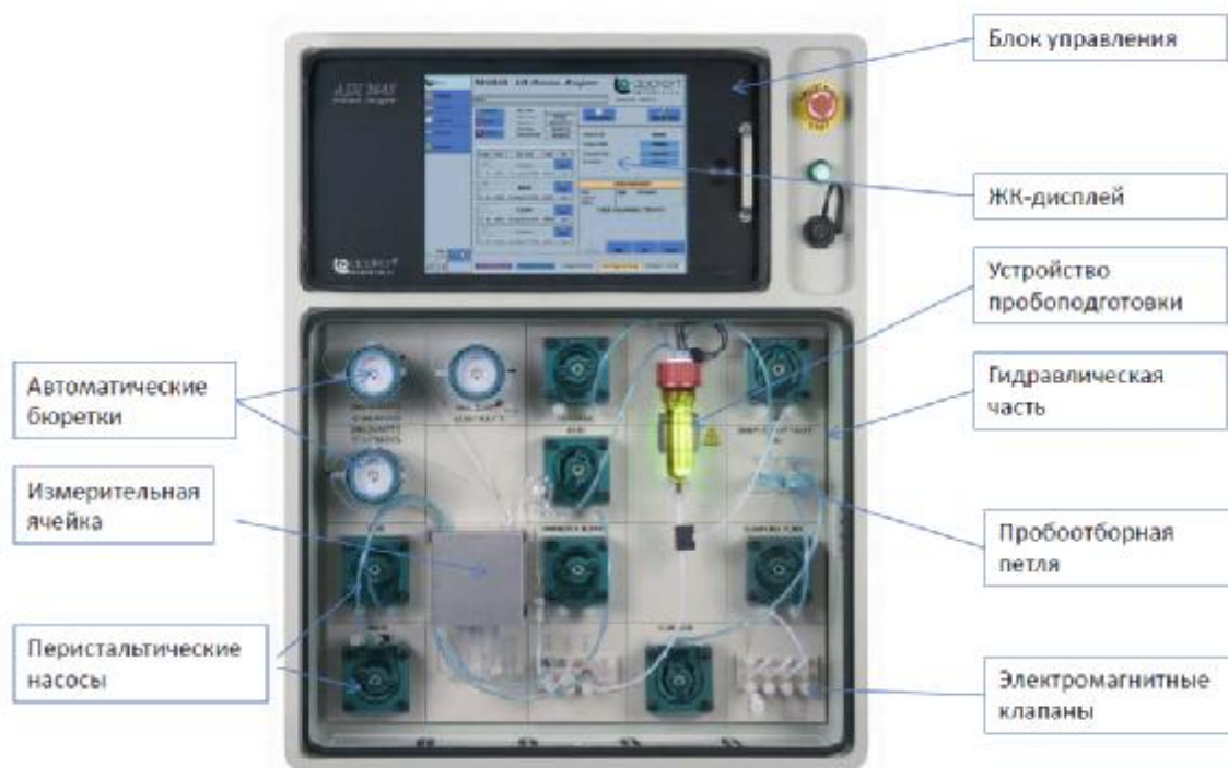
Рис. 2 Основные узлы анализатора ADI 2045 VA
